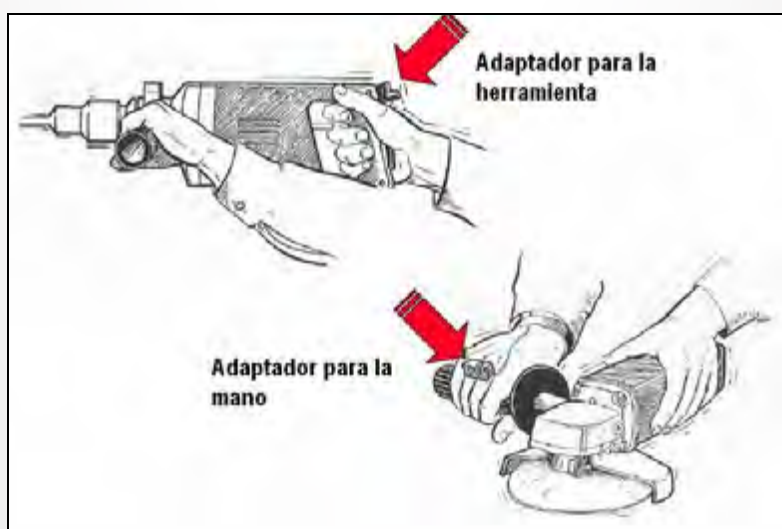
Figura 4. Posición correcta del acelerómetro, según el tipo de adaptador que se use.
